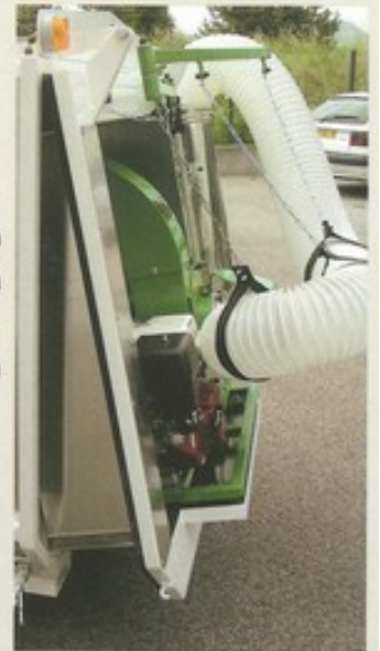
Porte ouvrante pour le vidage (le groupe d'aspiration reste parfaitement à la verticale). Benne avec structure en tube d'acier, habillage tôle aluminium.
