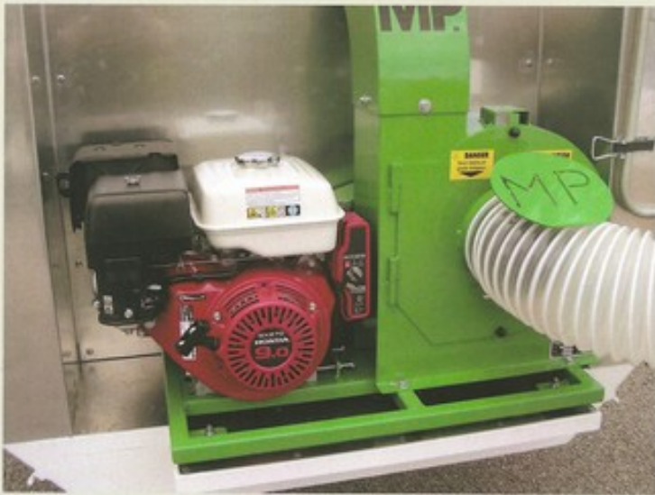
Groupe d'aspiration MP monté sur cadre avec silentblocs. Turbine avec porte ouvrante pour le nettoyage. Moteur Honda de 9 à 13 CV avec sécurité manque d'huile. (Possibilité d'entraînement par moteur hydraulique)
