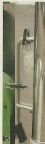
Attaches faciles pour la buse d'aspiration, fixées à l'AR de la benne
